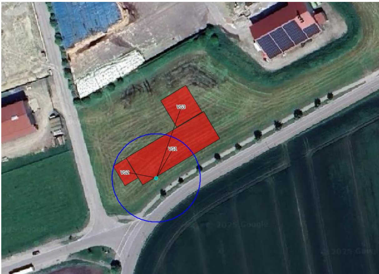
Abbildung 9: Einwirkungsbereich der Abgasableiteinrichtung nach VDI 3781 Blatt 4 für die Feuerungsanlage
