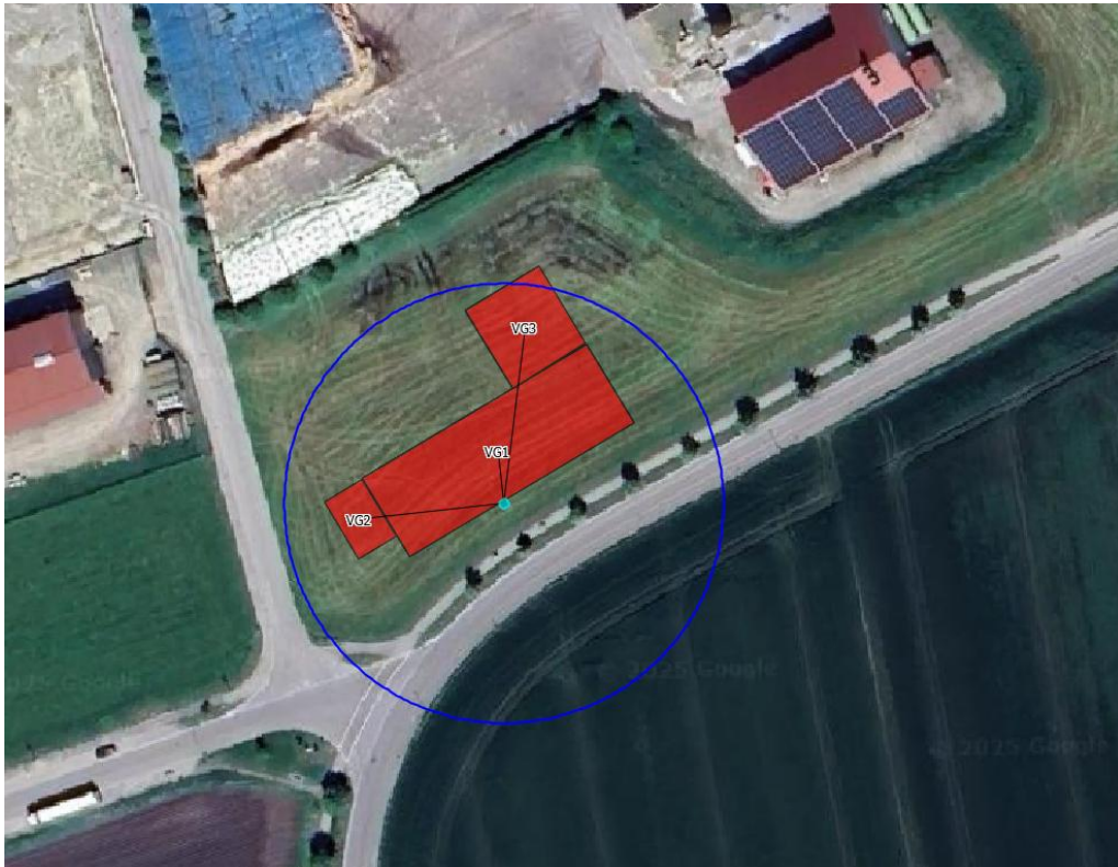
Abbildung 10: Einwirkungsbereich der Abgasableiteinrichtung nach VDI 3781 Blatt 4 für die Pyrolyseanlage
