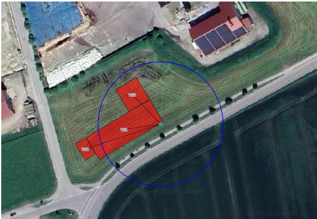
Abbildung 11: Einwirkungsbereich der Abgasableiteinrichtung nach VDI 3781 Blatt 4 für die Trocknungsanlage
